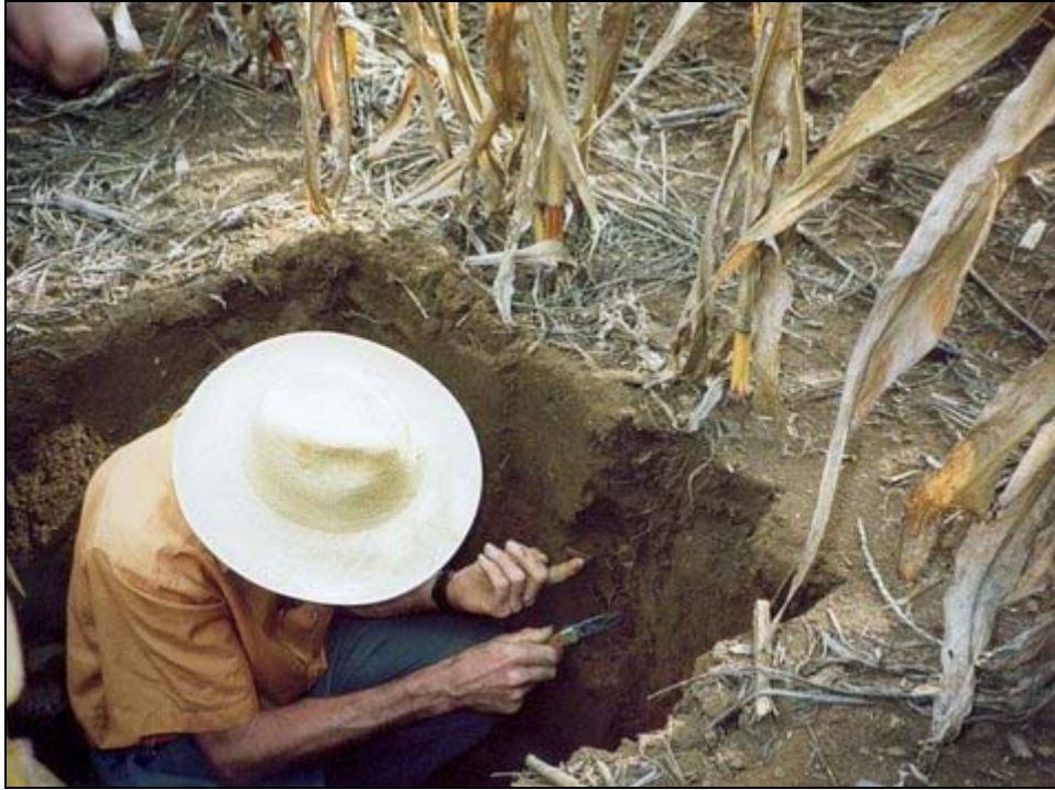
Avaliação da qualidade do solo pelo processo de trincheira
