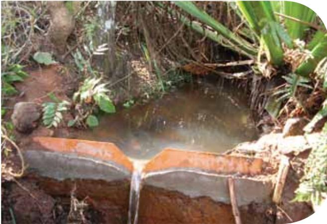
Vertedouro improvisado, para medição de vazão, sobre uma pequena barragem para captação de água, em uma das propriedades estudadas, cuja instalação e escolha do local mais apropriado se deu com a participação dos proprietários.
