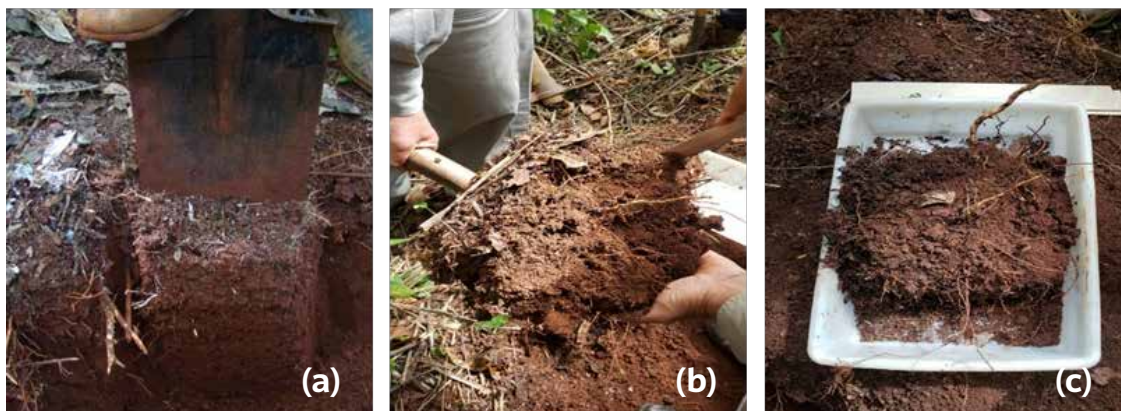
Figura 2. Etapas de amostragem do torrão para avaliação da estrutura físico do solo, seguindo método DRES (RALISHet al., 2017). (a) Corte com pá reta do torrão; (b) cuidadosa retirada do torrão da mini trincheira e (c) colocação do torrão na bandeja de avaliação.
