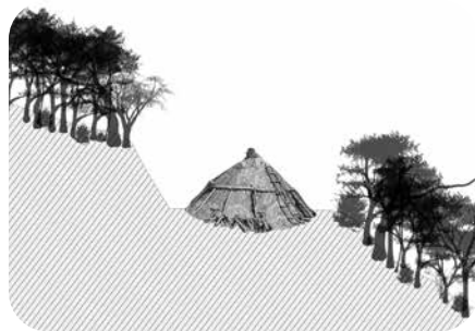
Esquema de uma carvoaria e seu balão de carvão
